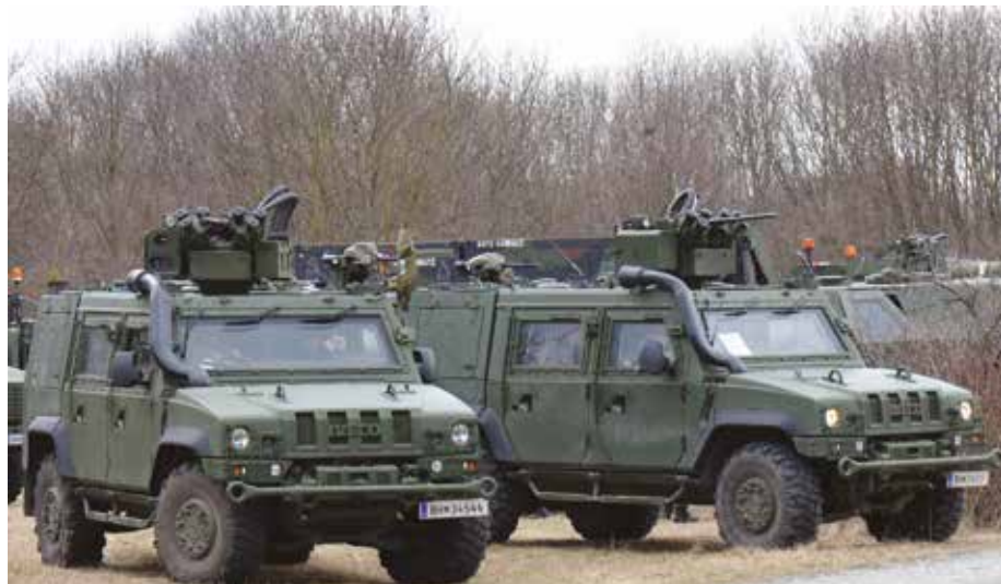
Abb. 1: Gehärtetes Mehrzweckfahrzeug IVECO Husar mit elektronischer Waffenstation mit überschwerem Maschinengewehr M2. (Foto: ABCAbwZ)
