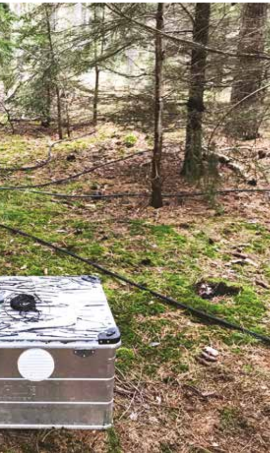
2: Ein Element der mobilen Infraschall-Messanlage (Quelle: ZAMG)
