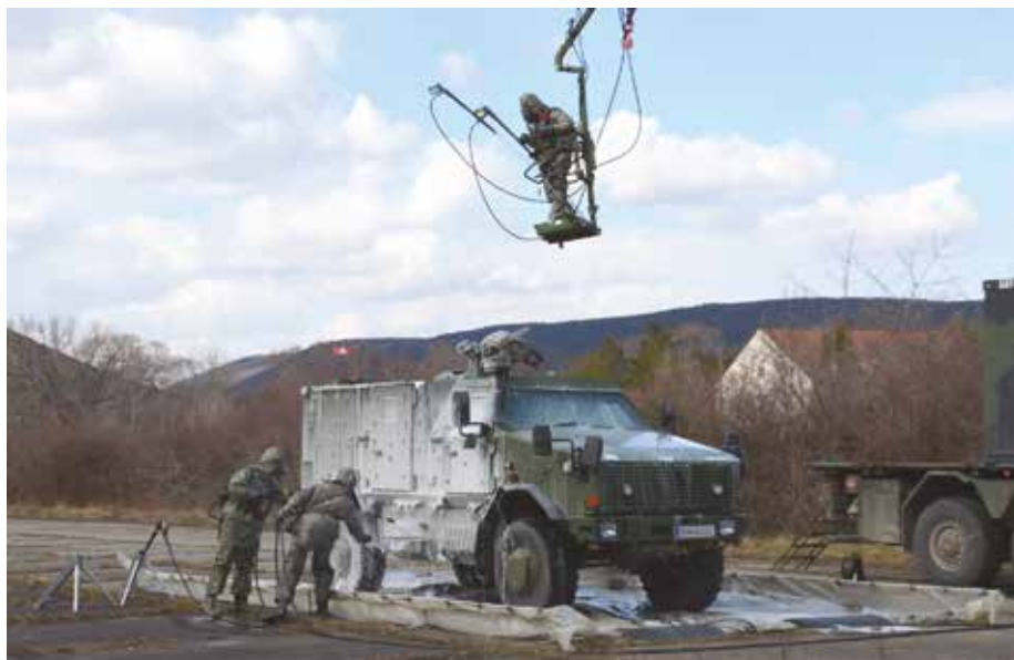
Abb. 2: Deko-Zug(KPE) bei der Dekontamination eines Allschutztransportfahrzeugs AC-Aufkl Dingo 2 nach dessen Rückkehr aus dem Einsatzgebiet. (Foto: ABCAbwZ)
