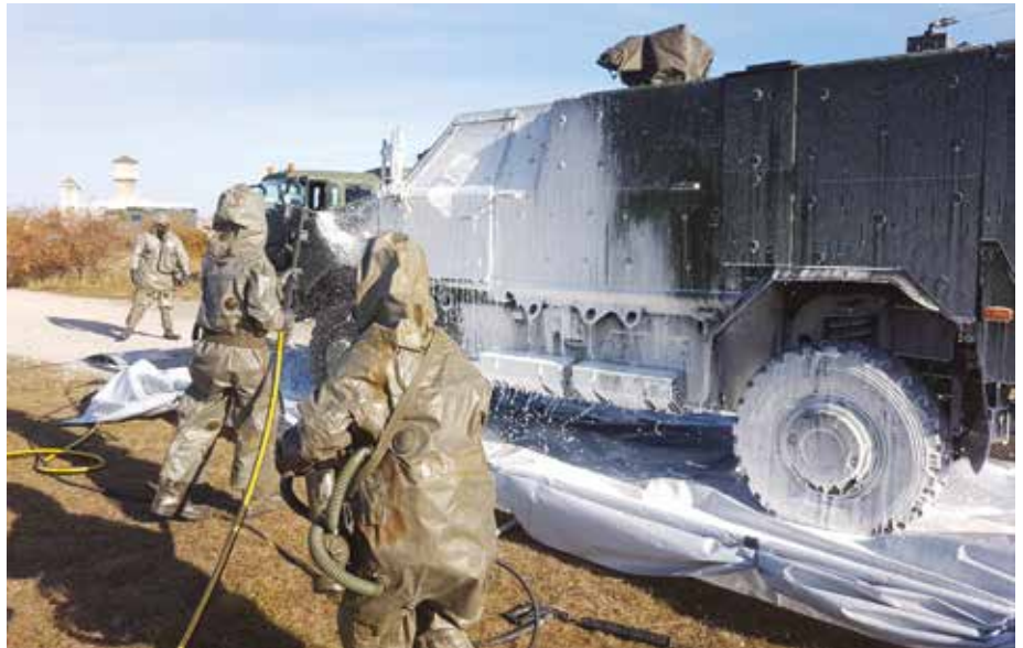
Abb. 2: Dekontamination eines AC-DINGO (Foto: Nikola Savić)
