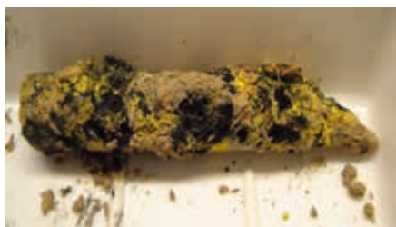
Abb. 3: Überreste eines DU-Geschosses (Bild: HZDR)
