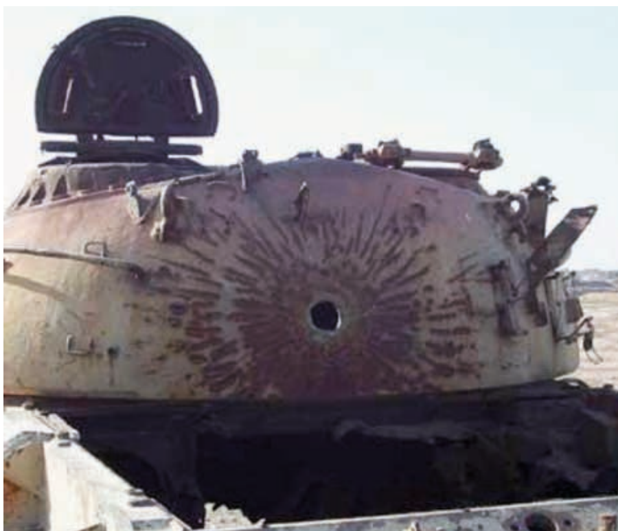
Abb. 4: Einschlag eines DU-Geschosses an einem Panzer (Bild: researchgate.net)
