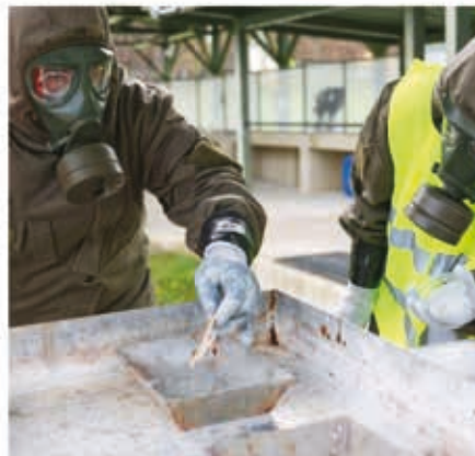
Abb. 3: Kampfstoffdetektion mit Kampfstoffnachweispapier (Bild: Leo Wegscheider)
