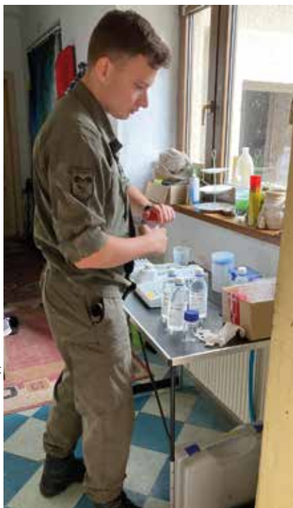
Mobile Trinkwasseranalyse vor Ort
