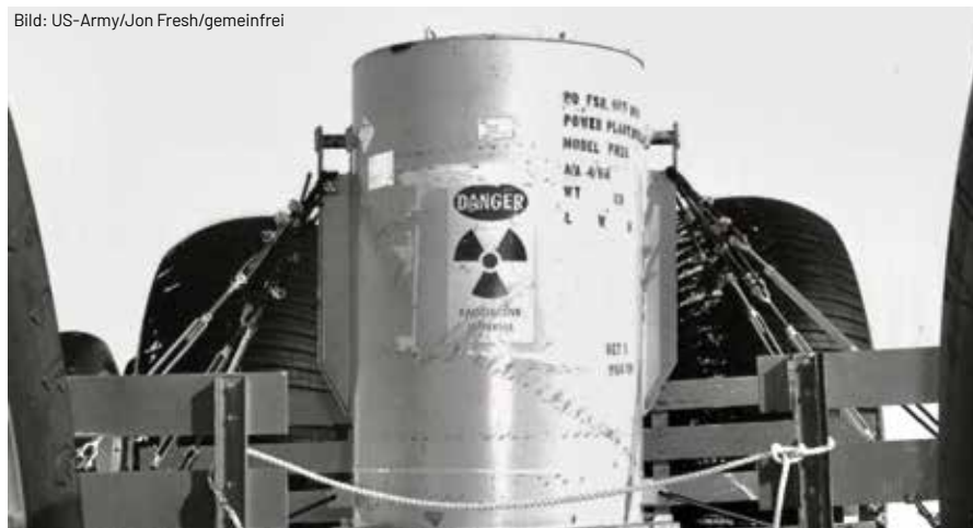
Abtransport der sieben Behälter mit abgebrannten Brennstäben aus dem modularen Reaktor PM-2A
